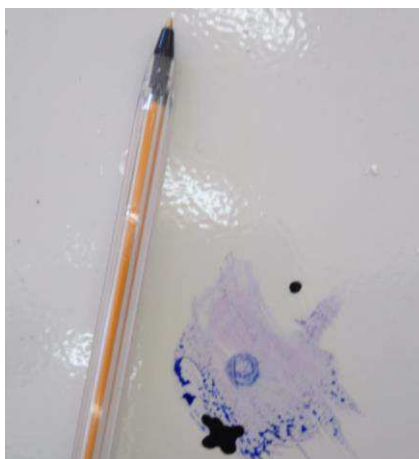
Figuras 16 e 17: Danos causados nos pontos centrais de protótipos– traço argamassa de 1: 0,25: 6
