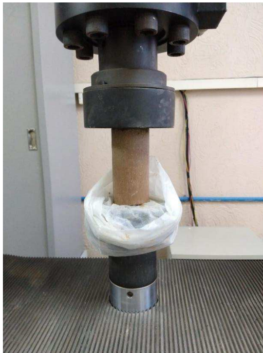
Figura 12 - Prensa utilizada no ensaio de resistência à compressão simples.
