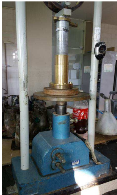
Figura 9 - Moldagem do corpo de prova – Compactação.
