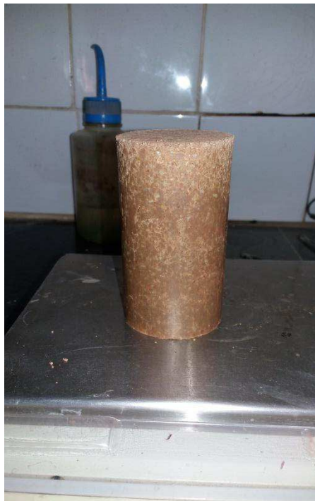
Figura 11 - Corpo de prova desmoldado, etapa de medição e pesagem.
