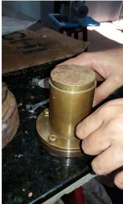
Figura 11 - Corpo de prova desmoldado, etapa de medição e pesagem.
