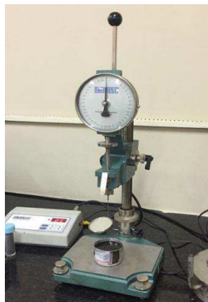
Figura 8 – Aparelho utilizado para realização do ensaio de penetração
