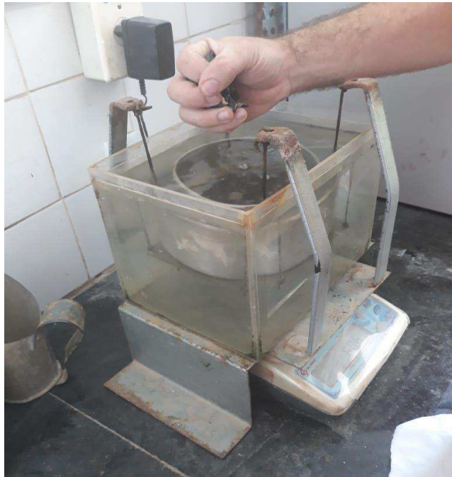
Figura 15: Agregados graúdos sendo pesados na condição submersa
