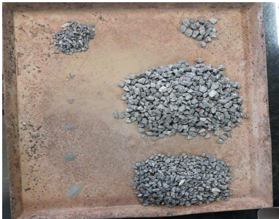
Figura 14: Ensaio de granulometria
