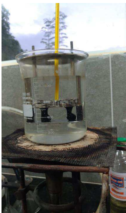
Figura 12: Ensaio de ponto de amolecimento
