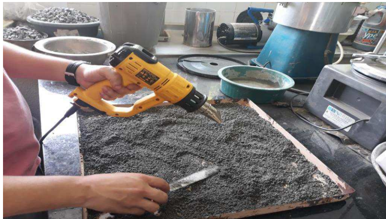
Figura 16: Secagem da amostra com circulador de ar quente
