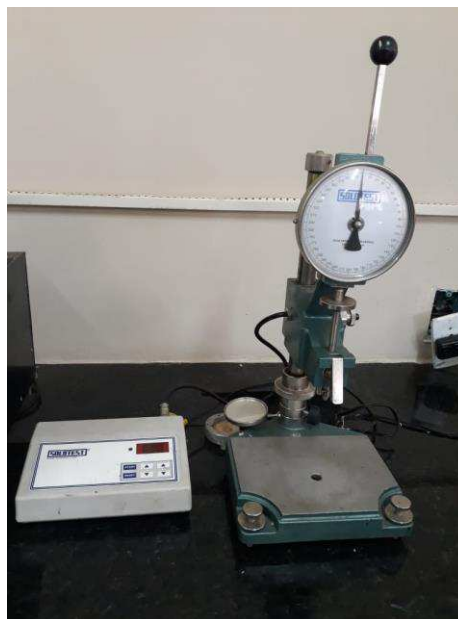
Figura 11: Penetrômetro utilizado no experimento
