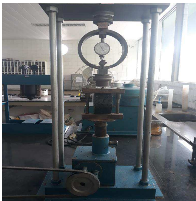
Figura 18: Ensaio de compressão diametral
