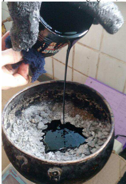
Figura 2 – Composição da mistura asfáltica: agregados, fíler e ligante asfáltico
