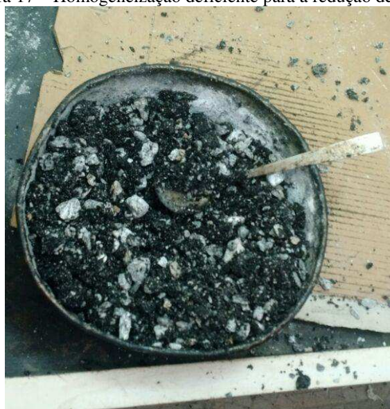
Figura 17 – Homogeneização deficiente para a redução de 20 °C
