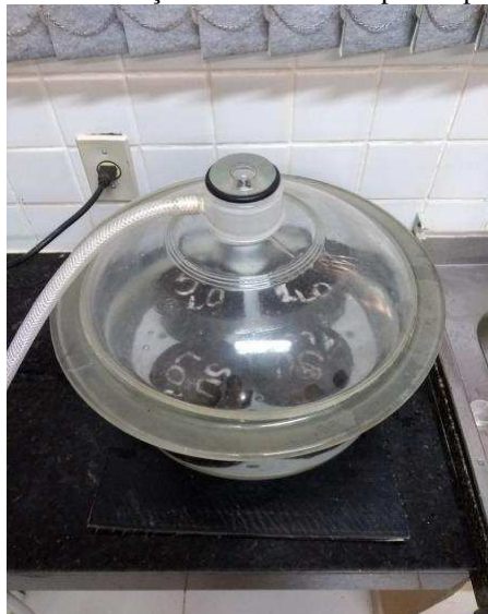
Figura 21 - Processo de saturação à vácuo dos corpos de prova condicionados
