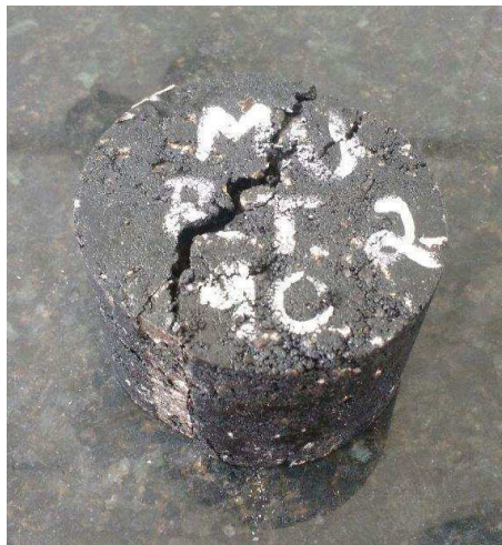
Figura 18 – Aspecto do corpo de prova após ruptura no ensaio de resistência a tração por compressão diametral
