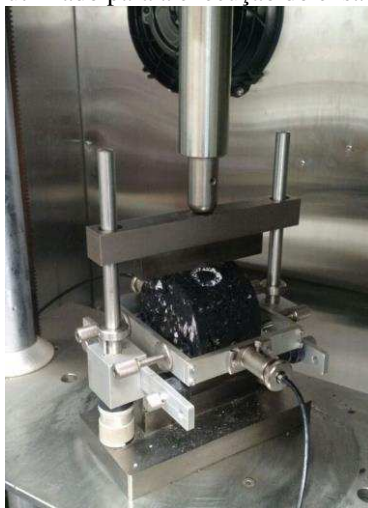
Figura 20 - Equipamento utilizado para a execução do ensaio de módulo de resiliência
