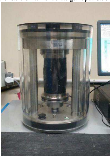
Figura 25 – Realização do ensaio uniaxial de carga repetida e obtenção do FN na AMPT
