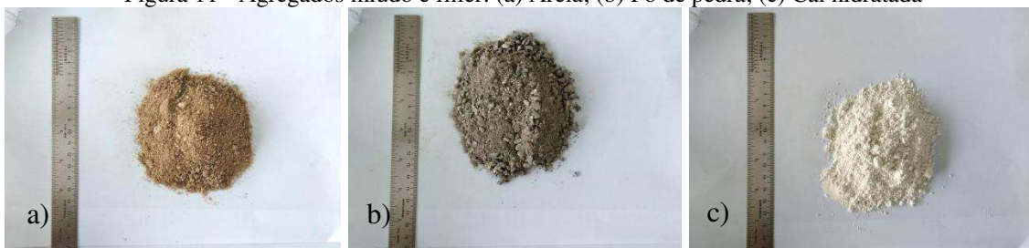
Figura 11 - Agregados miúdo e filler: (a) Areia; (b) Pó de pedra; (c) Cal hidratada
