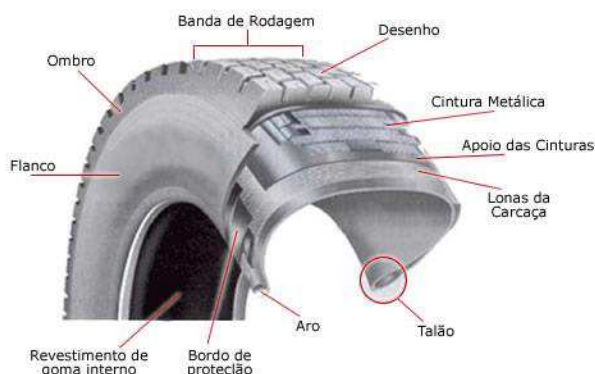
Figura 2: Composição do pneu
