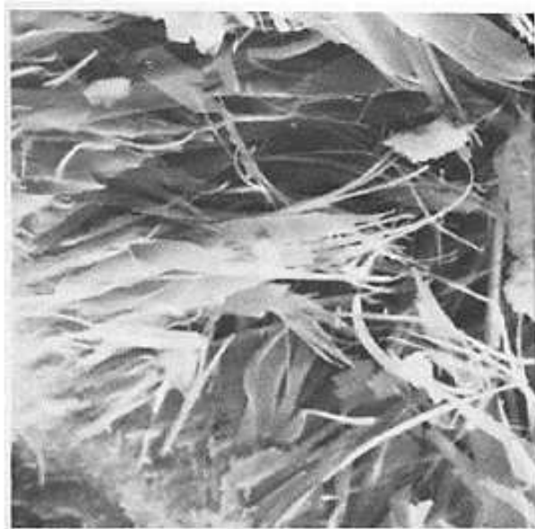
Figura 5 - Fotomicrografia da pasta de cimento Portland endurecida.
