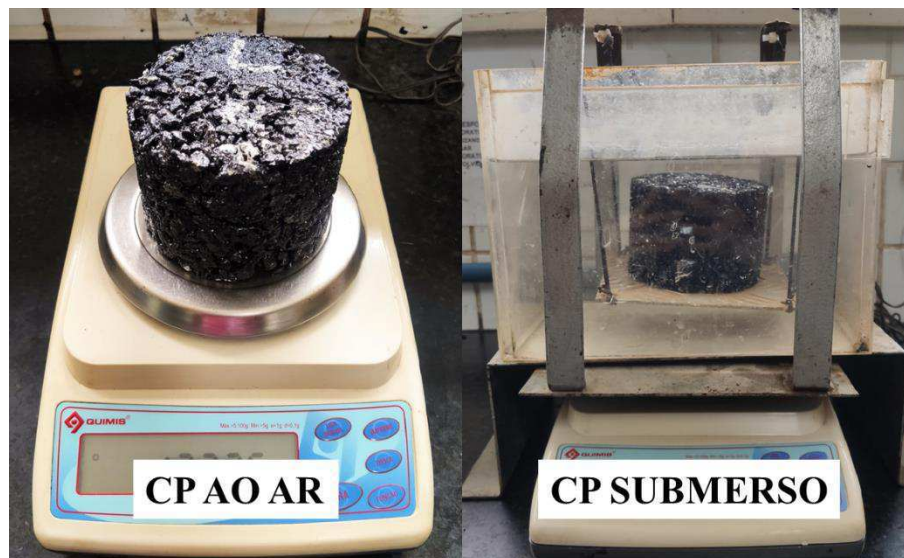
Figura 27- Procedimento de ensaio, vazios comunicantes.
