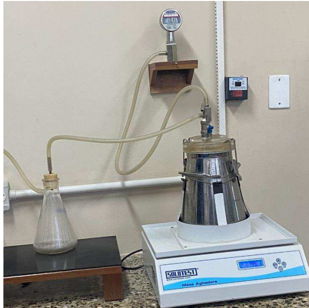
Figura 17- Aparelhagem para determinação da densidade máxima da mistura (Rice)
