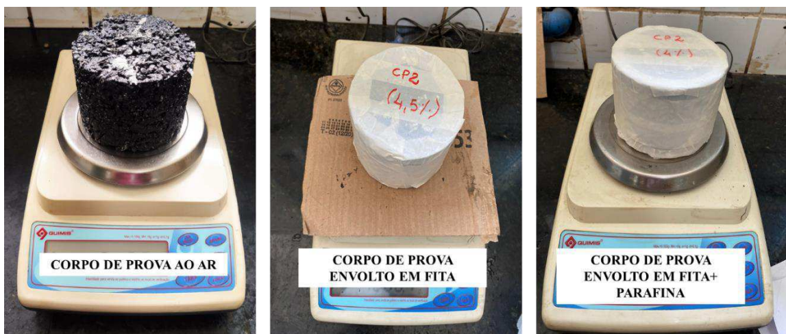
Figura 16- Procedimento de ensaio para determinação da densidade aparente da mistura.
