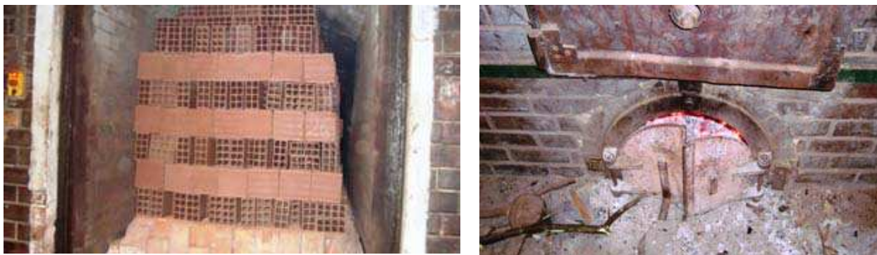
Figura 13 – Tijolos empilhados para queima nos fornos(a) e forno da olaria (b).
