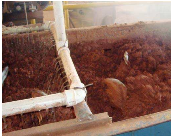
Figura 9 - Misturador, local onde se controla a umidade da matéria-prima.
