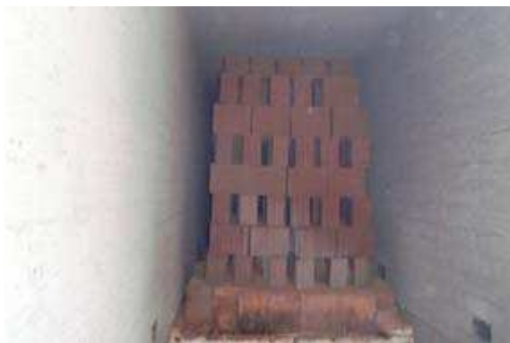
Figura 12 – Antecâmara de secagem de tijolos.
