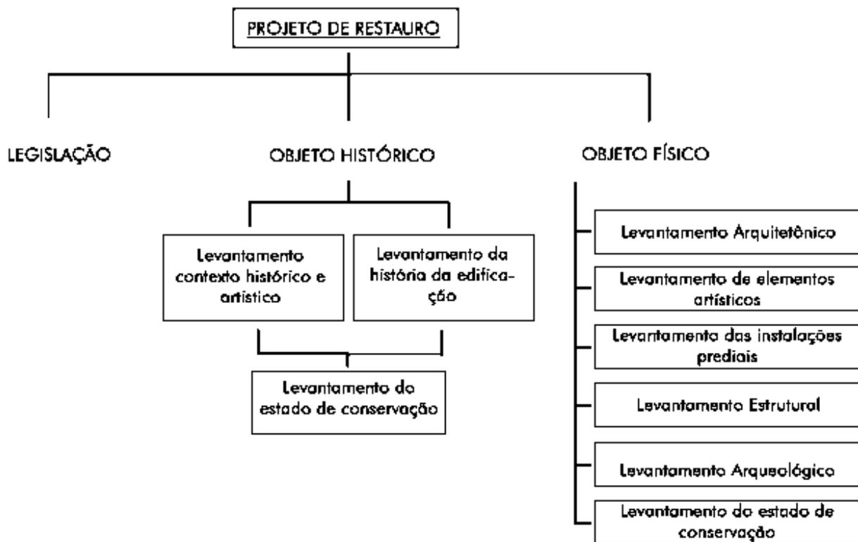
Figura 3. Diagrama da metodologia de um projeto de restauro em uma edificação. Fonte: Montagem de AFONSO baseado nas vertentes de RIBEIRO, 2016.
