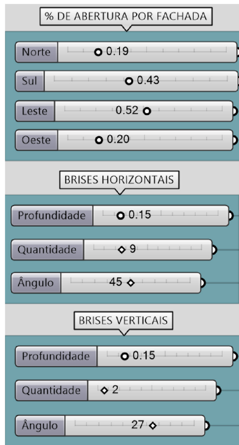
Figura 44: Parâmetros de aberturas e elementos de sombreamento no cenário 01
