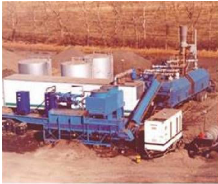
Figura 5 - Exemplo de estação de dessorção térmica no campo (SOUZA & LIMA, 2002)
