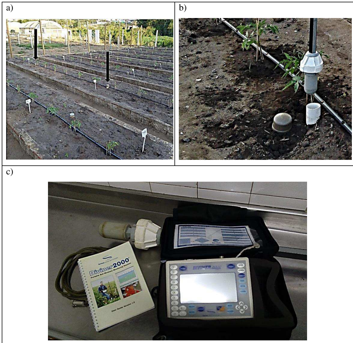
Figura 9. Monitoramento de água no solo. a) posicionamento dos tubos em PVC instalados nos canteiros; b) processo de coleta da umidade do solo realizados em dias de cada semana de estudo; c) equipamento (Diviner 2000)
