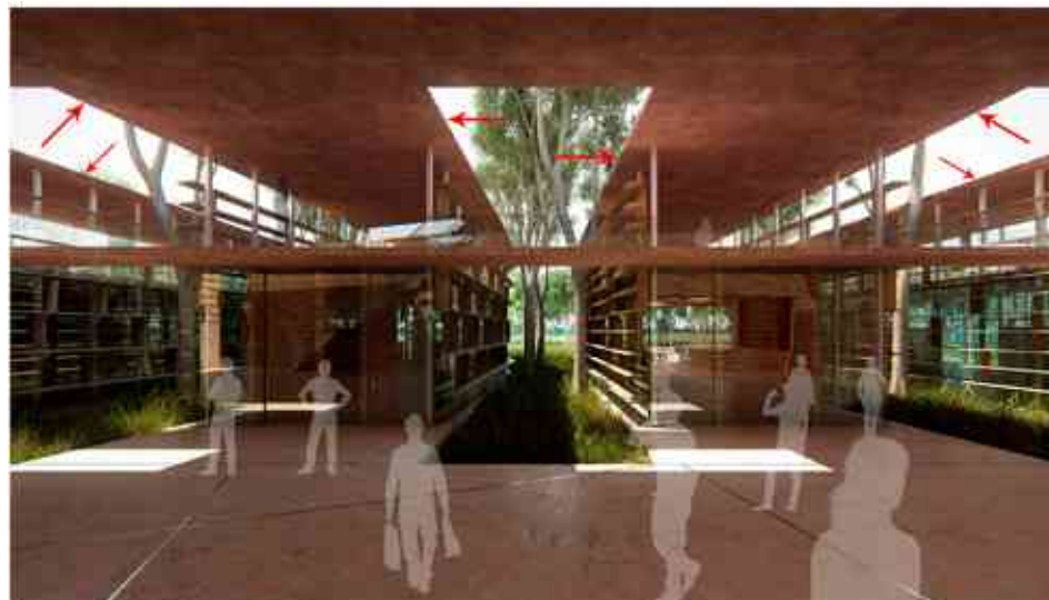
Figura 28: Beirais na cobertura do edifício (setas vermelhas). Fonte: PENNA, G. A., 2020 (Adaptada).
