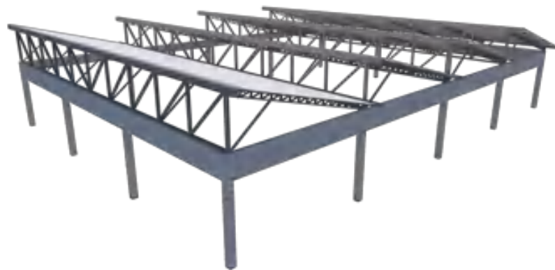
Figura 42: Perspectiva do esquema estrutural da coberta do ginásio
