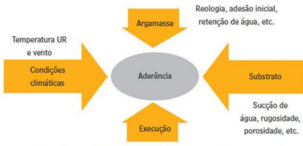
Figura 13 – Fatores que exercem influência na aderência de argamassas sobre hastes porosas.
