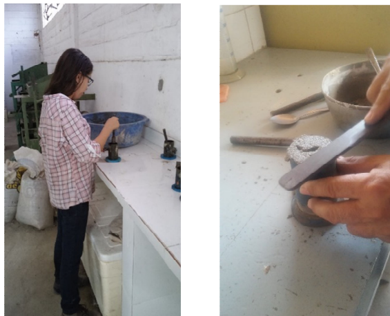
Figura 25 – Moldagem corpos de prova
