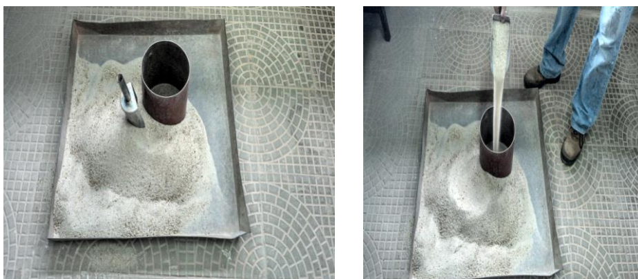
Figura 13: Execução do ensaio de determinação da massa unitária no estado solto
