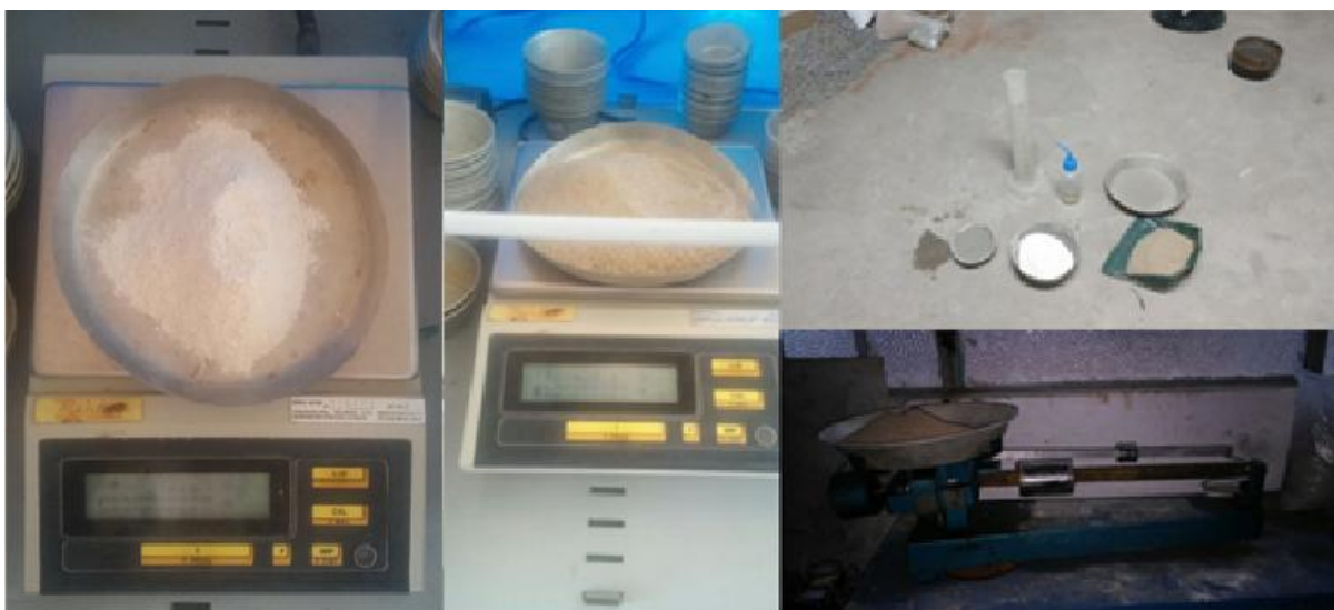
Figura 14: Pesagem dos materiais constituintes da argamassa
