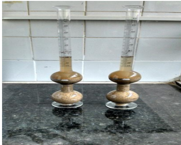
Figura 12: Determinação da massa específica do agregado miúdo - Frasco Chapman
