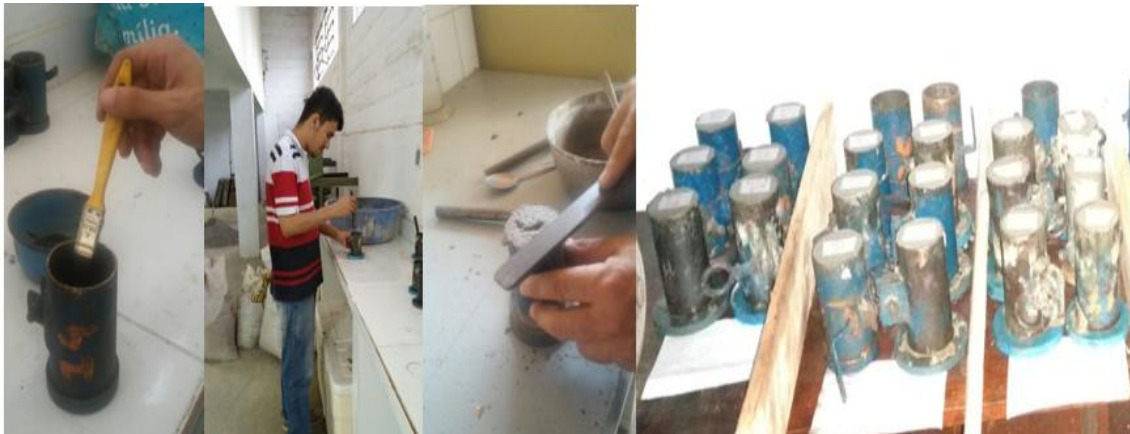
Figura 16: Produção da argamassa e moldagem dos corpos de prova
