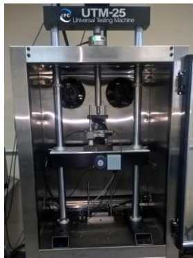
Figura 22 – Equipamento utilizada no Ensaio de Módulo de Resiliência
