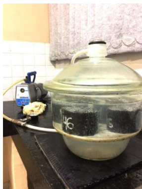
Figura 23 – Aplicação do vácuo nos corpos de prova (Ensaio de Lottman Modificado)
