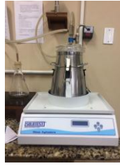
Figura 6 – Ensaio para encontrar os parâmetros volumétricos (Rice Test)
