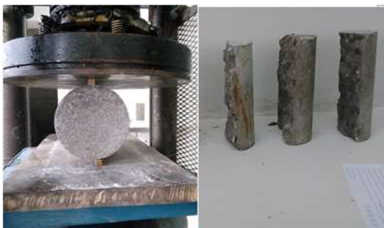
Figura 7 - Ensaio de tração e corpos de prova rompidos
