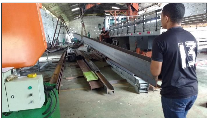
Figura 27. Funcionários posicionando perfil para corte
