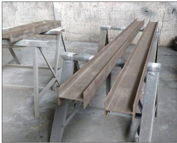
Figura 46. Perfis posicionados para pintura sobre cavalete metálico
