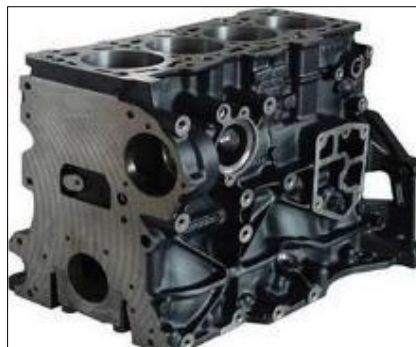
Figura 11. Motor de ferro fundido
