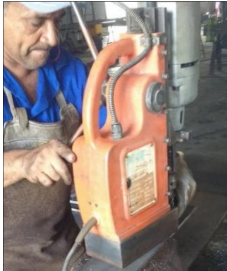
Figura 29. Funcionário executando perfuração com máquina perfuradora
