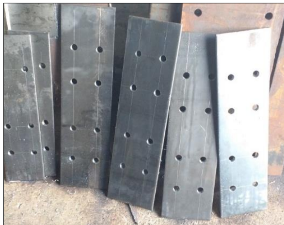
Figura 30. Chapas metálicas perfuradas
