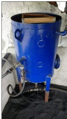
Figura 43. Tonel de armazenamento de granalha
