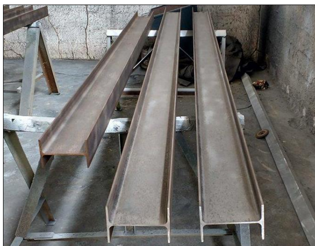
Figura 45. Perfis pós tratamento com granalha de aço
