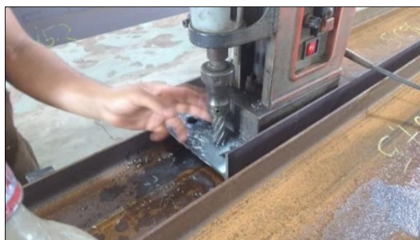
Figura 31. Posicionamento de perfil para execução de furos
