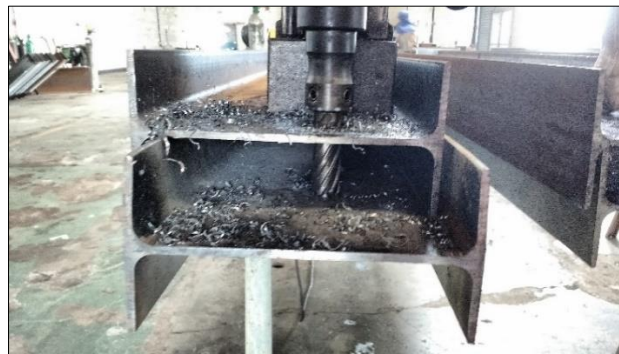
Figura 33. Perfil totalmente perfurado
