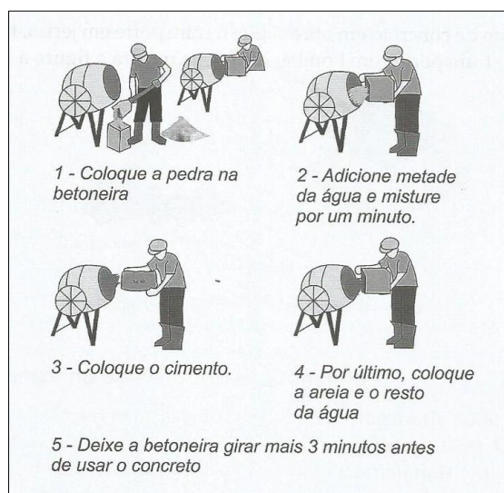
Figura 18. Preparação mecanizada de concreto
