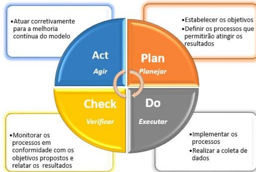
Figura 4 - Princípio de funcionamento do ciclo PDCA
