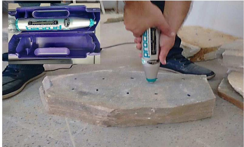
Figura 25. Estrutura do Martelo de Schimdt modelo Proceq Tradicional portátil (esquerda) e ensaio de resistência em pontos de quartzito com martelo de Schimdt, propriedade da UFCG/UAMG. (Barbosa Neto, 2016).
