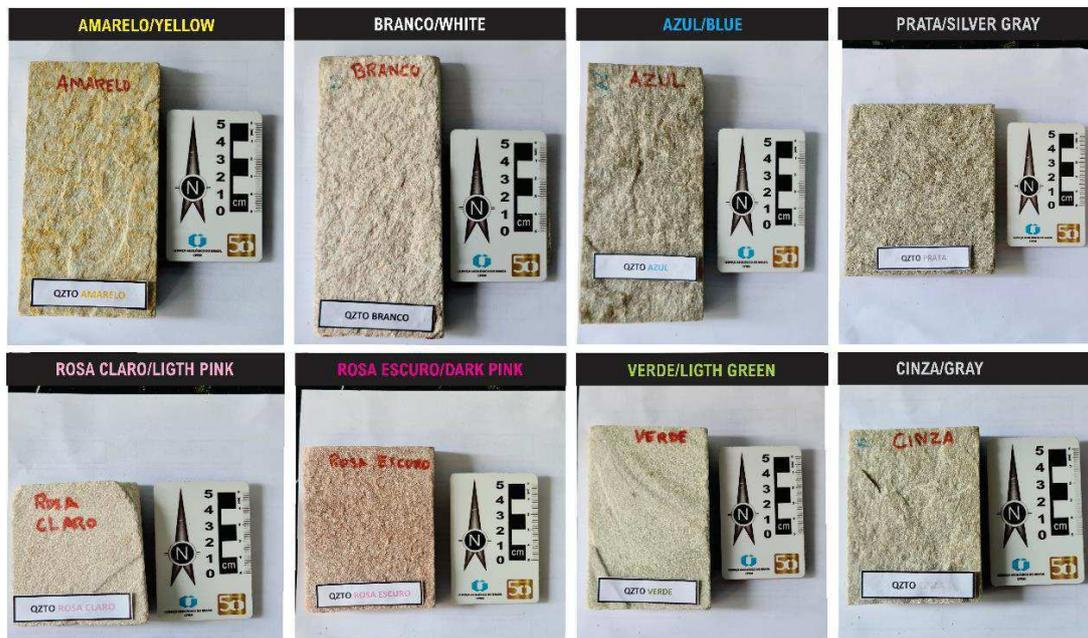
Figura 02. Amostras coletadas nas serras da Poção (Várzea) e Carneira (Junco do Seridó), para ensaios tecnológicos.
