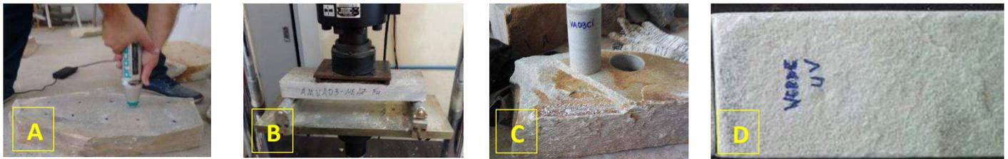
Figura 07. Alguns dos ensaios prévios tecnológicos realizados em quartzitos pelo GEBMBS: A) Resistência a compressão Uniaxial (Barbosa Neto, 2016), B) Resistência a Flexão em 03 e 04 pontos (Freitas, 2016), C) Porosidade (Cirilo, 2016) e, D) Radiação Ultravioleta (Albuquerque, 2017).
