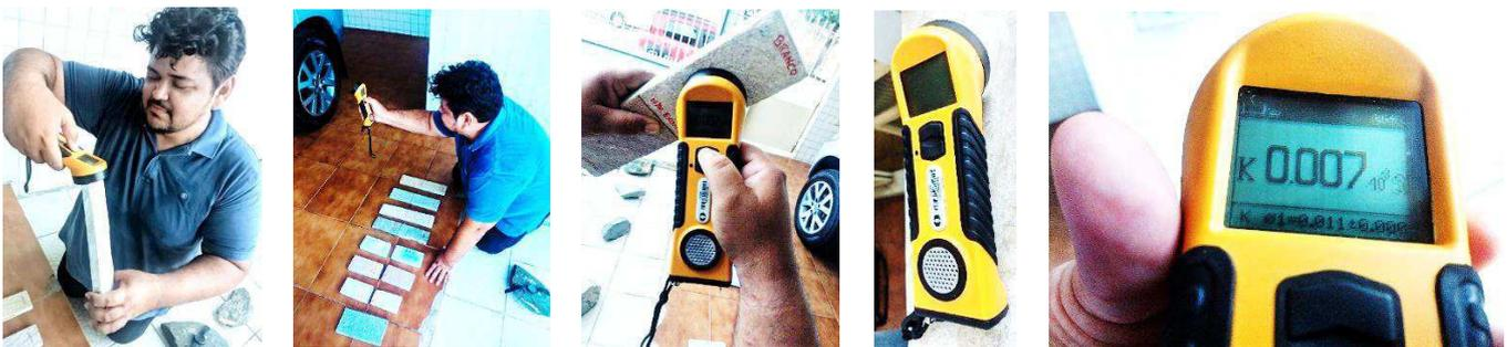
Figura 05. Medição de susceptibilidade magnética com equipamento tipo *Kappameter* KT-09 simulando análise em fragmento de rocha.
