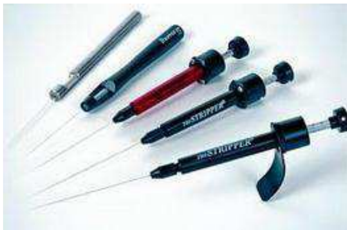
Figura 11 – Pipetas de desnudamento flexipet usadas na manipulação de embriões à vitrificação. Fonte: http://www.origio.com .
