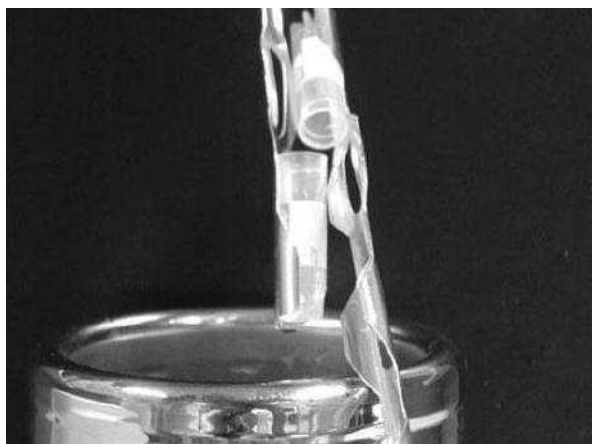
Figura 13 – Amostra sendo diretamente coberta por nitrogênio líquido na DVC (Direct Cover Vitrification). Fonte: Carvalho et al. (2011).
