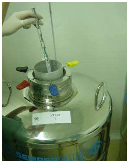
Figura 7 - Botijão de N 2 L para armazenamento dos embriões. Fonte: http://g1.globo.com/ciencia-e-saude .
