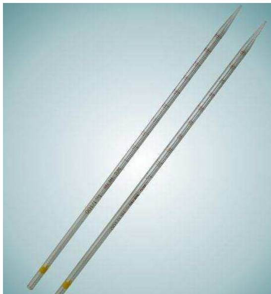
Figura 10 – Micropipetas de vidro utilizadas para o processo de vitrificação. Fonte: http://www.consuitec.com.br .
