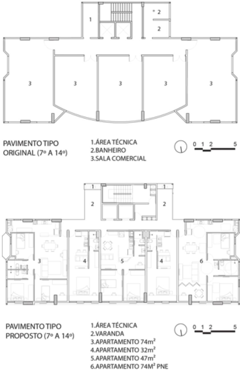
**Figura 31:** Evolução do Pavimento Tipo. **Fonte:** Autoria Própria
