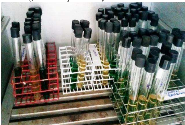
Figura 7: Tubos com caldo verde bile e caldo triptona em estufa bacteriológica a 45° C para incubação em 24 horas
