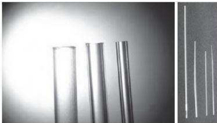
FIGURA 3: COMPARAÇÃO DO DIÂMETRO ENTRE A PALHETA CONVENCIONAL (1,7 MM) OPS (0,8 MM) E GMP (0.3 MM).
