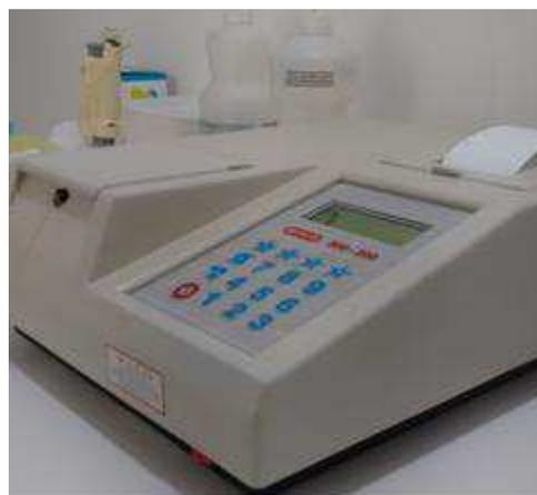
**Figura 4:** Aparelho semiautomático de análise bioquímica.
