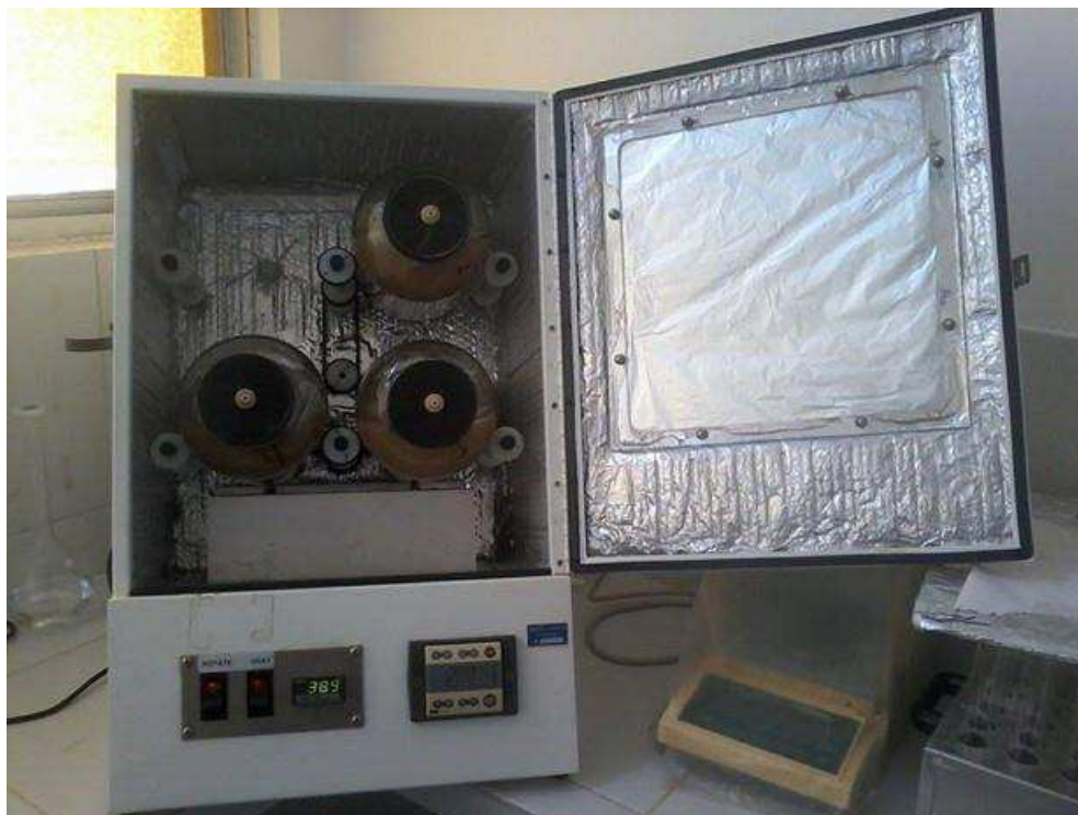
Figura 2. Daysi incubator com jarras contendo amostras em seus respectivos tratamentos
