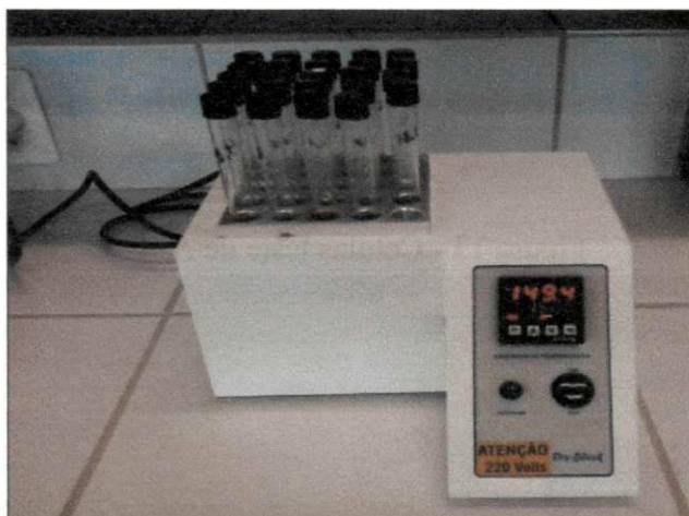
Figura 12 - Bloco Digestor para ensaio de DQO.
