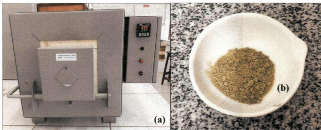
Figura 6 - Ilustração do ensaio de sólidos totais: (a) Mufla e (b) Resíduo calcinado.
