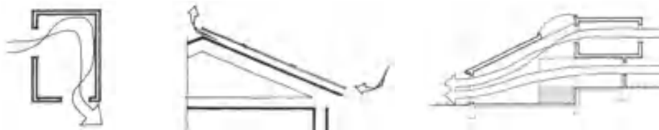
Figura 20 - Ventilação cruzada, em planta (esquerda); Ventilação pela cobertura (centro); Ventilação cruzada, elevação (direita).
