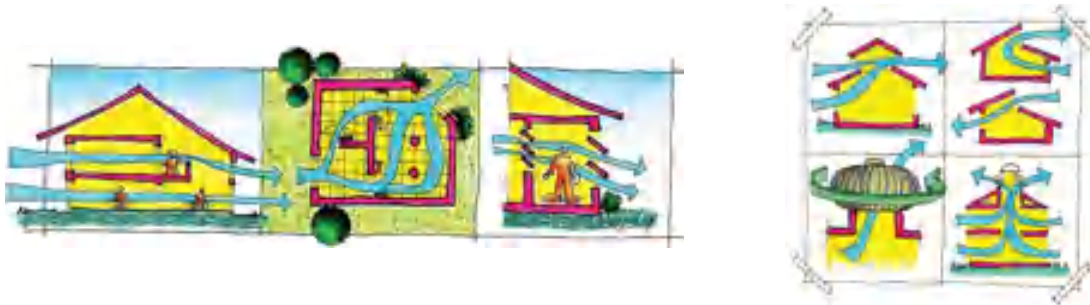
Figura 19 - Espaços fluidos (esquerda); Ventilação vertical (direita).
