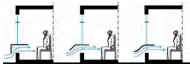
Figura 26 - O desempenho do peitoril ventilado é influenciado pelo formato adotado.
