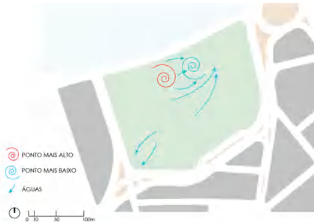
Figura 48 - Representação esquemática da direção de fluxo das águas
