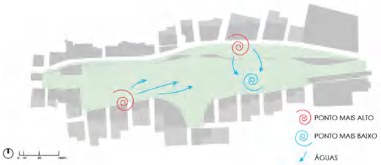
Figura 33 - Representação esquemática da direção de fluxo das águas
