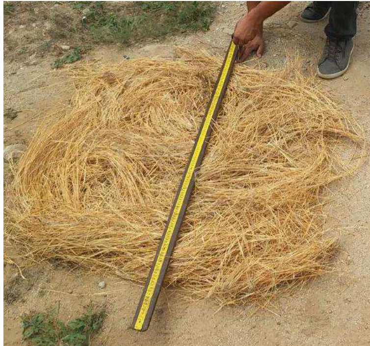
Figura 3 - Medição da espessura da pilha antes da queima do material combustível.
