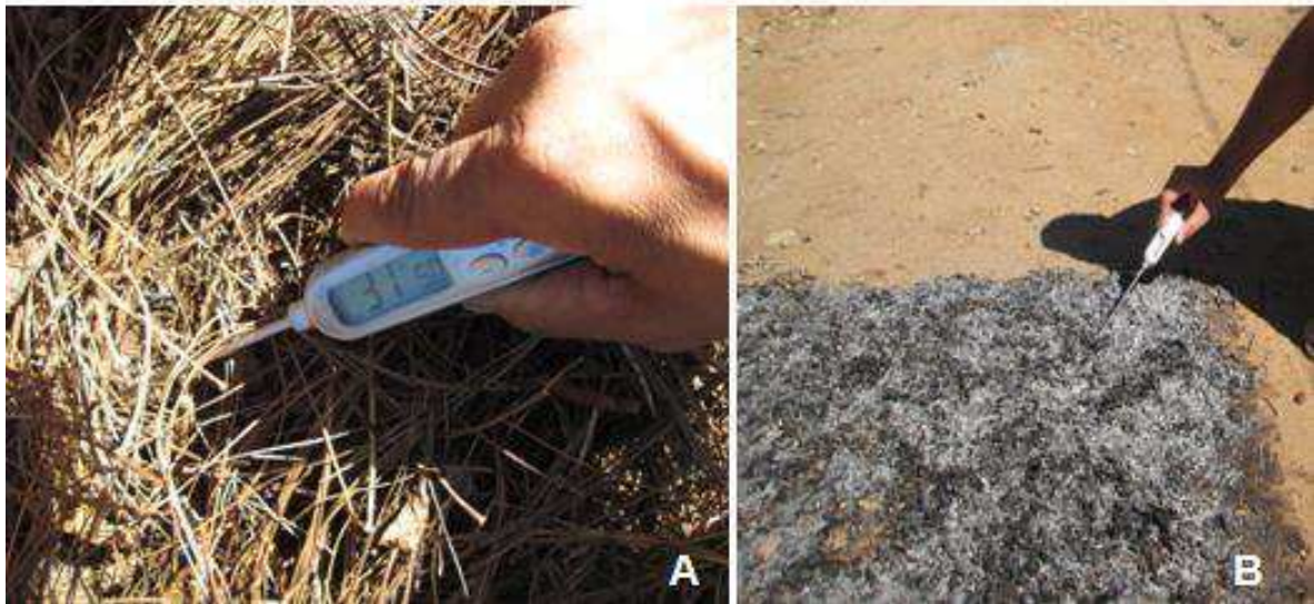
Figura 4 - Medição da temperatura do solo antes (A) e após a queima do material combustível (B) utilizando o termômetro digital.
