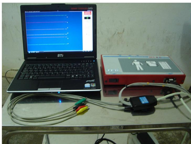
Figura 1- Eletrocardiógrafo computadorizado
