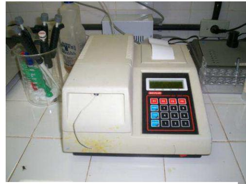
**Figura 12.** Analisador Bioquímico - Bioplus 2000/ Laboratório de Patologia Clínica do Hospital Veterinário/CSTR /UFPG,Patos/PB.
