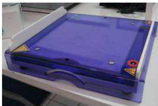
Figura 5 - Cuba de transferência vertical *semi-dry* (semi-seca).
