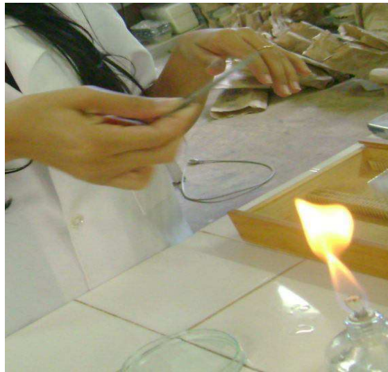
Figura8: Flambagem das lâminas
