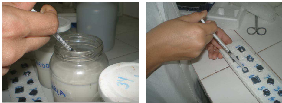
Figura 8 – Captação do inóculo com 0,1mL de amostra e sua deposição na ampola do Delvotest ® .
