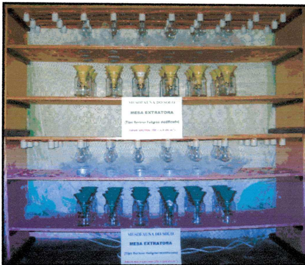
Figura 11. Aparato de Berlese-Tullgren para coleta dos organismos da mesofauna do solo nos tratamentos onde foram aplicados o biofertilizante bovino comum e vinhaça, irrigado com água não salina e salina
