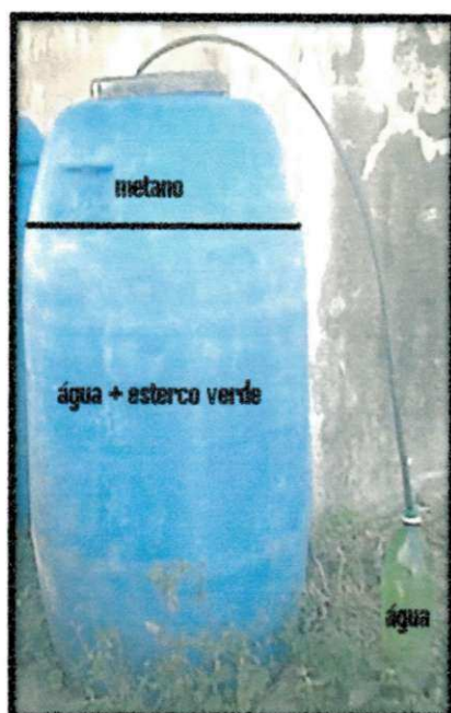
Figura 5. Produção do biofertilizante bovino via fermentação anaeróbica (Rodolfo Júnior, 2007)
