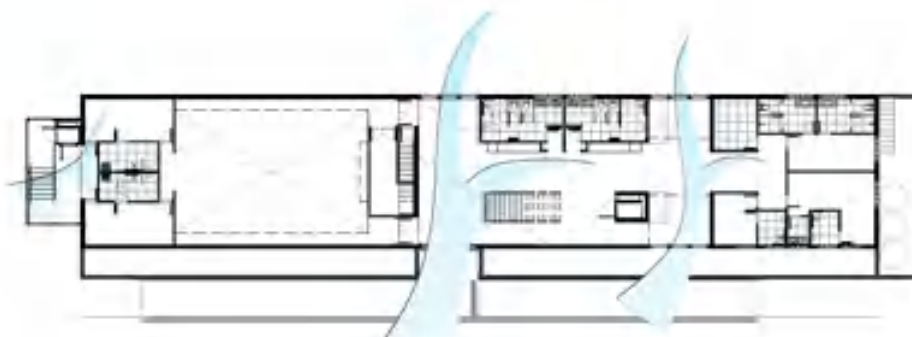
FIGURA 105: Permeabilidade dos ventos no interior da edificação.
