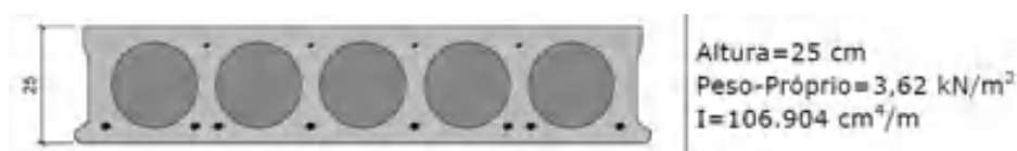
FIGURA 102: Corte e informações da laje alveolar utilizada.
