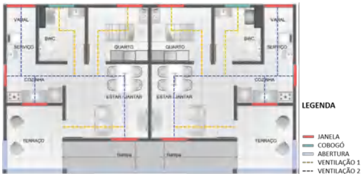
Figura 37: Ventilação, aberturas para entrada e saída de ar.
