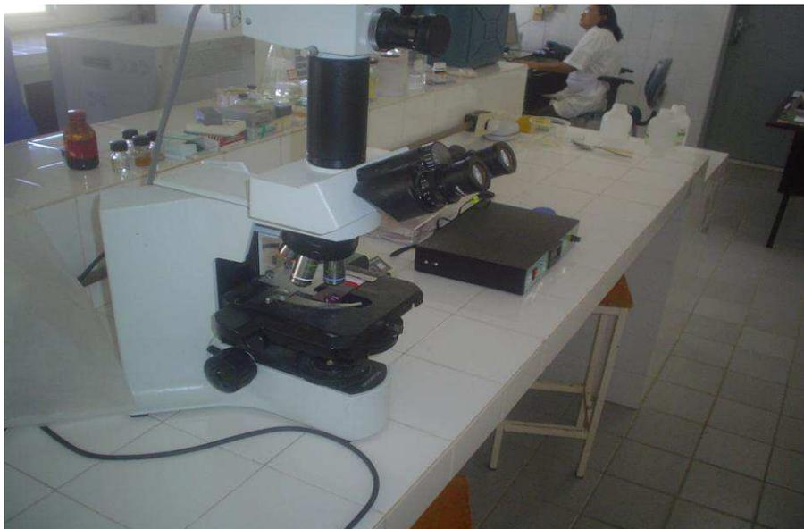
**Figura 6.** Microscópio de contraste de fase.
