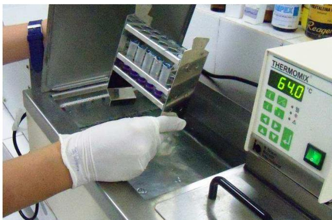
**Figura 4-** As amostras mantidas em banho-maria à temperatura de  $64^{\circ}\text{C} \pm 0,5^{\circ}\text{C}$  por 3 horas.
