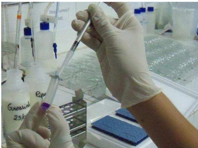
**Figura 3-** Adição de 0,1 mililitro de leite em cada ampola, com auxílio de uma pipeta calibrada.
