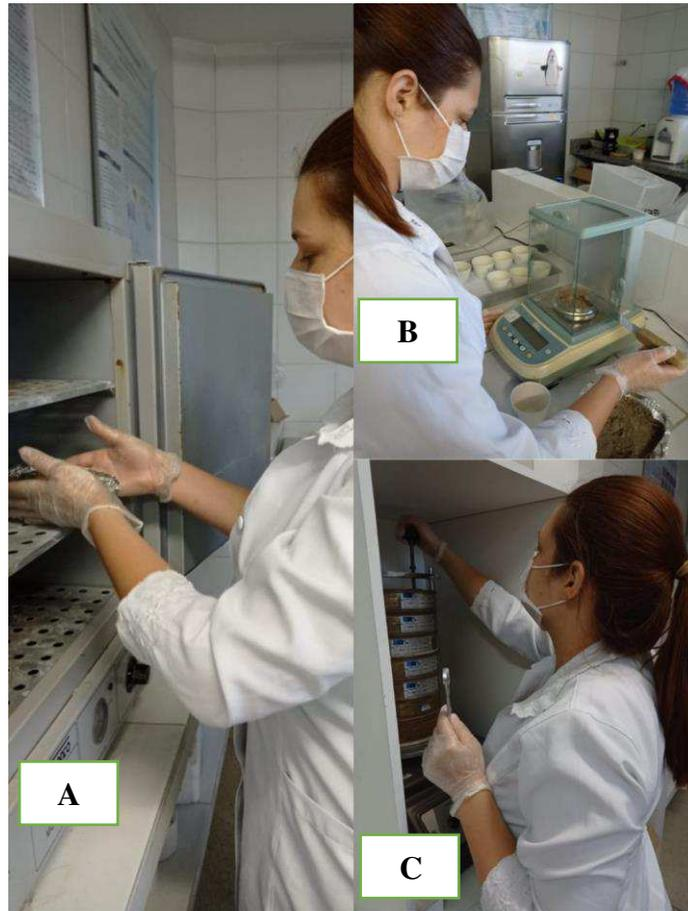
A: Sedimento levado para a secagem na estufa; B: Pesagem do sedimento na balança analítica; C: Máquina Rot-up.
