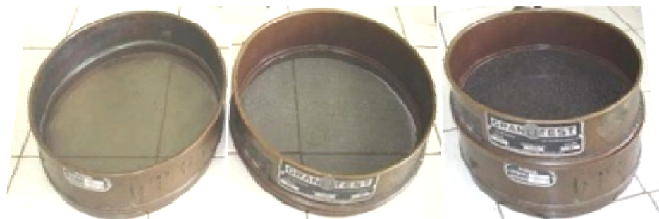
Figura 6 — Peneiras classificatórias de 40 mesh e 60 mesh
