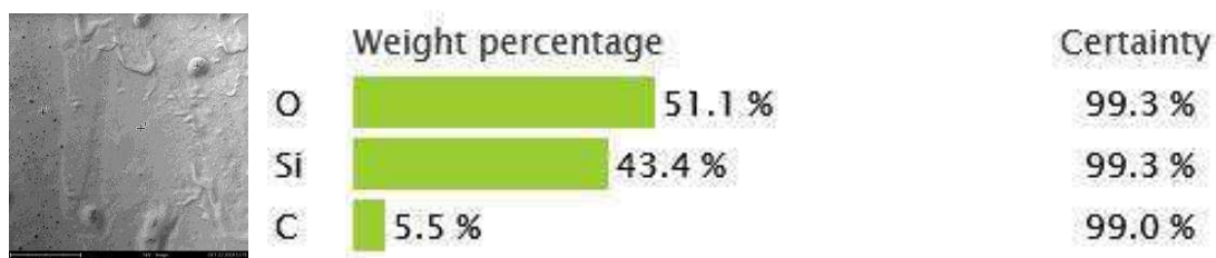
Figura 14 – Análise química por EDS da face externa da amostra PS
