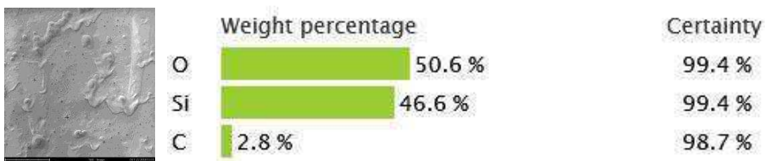
Figura 17 – Análise química por EDS da face interna da amostra PL
