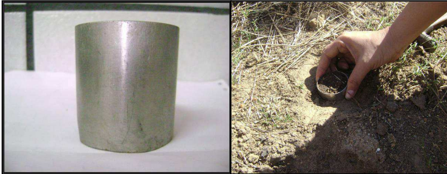
FIGURA3 —Anel metálico utilizado para coleta dos organismos do solo.
