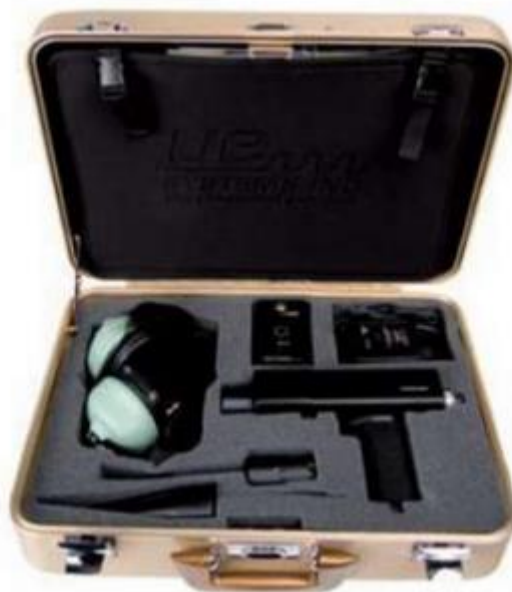
Figura 4. Fotografia de equipamento utilizado para inspeção por ruído ultrassônico.
