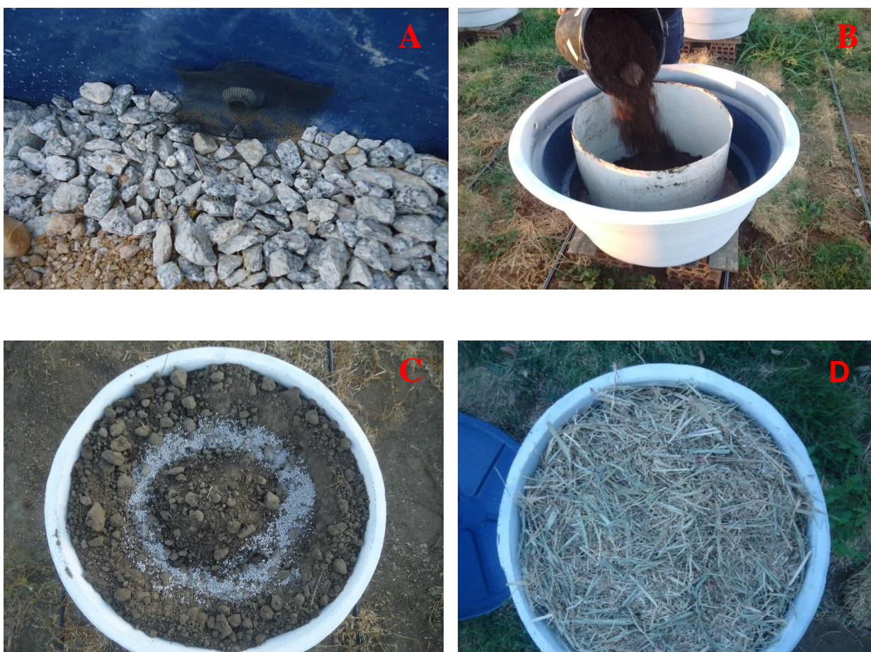
Figura 2 - Preenchimento dos lisímetros, formação do dreno brita + areia e registro (A), uso do cilindro para auxiliar no preenchimento (B), adubação fosfatada (C) e o lisímetro pronto com a cobertura morta (D).
