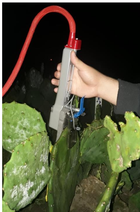
Figura 10. Mensuração das trocas gasosas em palma forrageira com utilização de analisador de gás infra vermelho e pinça adaptada ao cladódio (IRGA). Campina Grande, PB, 2020.
