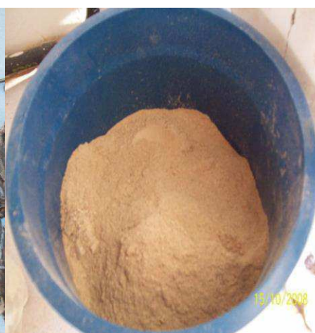
Figura 8: Cascas depois de moída em moinho industrial, Thomas Wilei, Laboratory Mill, model 4.
